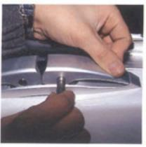
30 Klappflügel einsetzen Beim anschließenden Zusammenbau der Klampe erst einen Flügel einlegen, dann den Bolzen – leicht gefettet – ohne großen Druck einschlieben. Danach die Gummikugel ins Gelenk einlegen, den zweiten Flügel in der Führung einrasten lassen und ebenfalls von Hand mit dem Bolzen verriegeln
